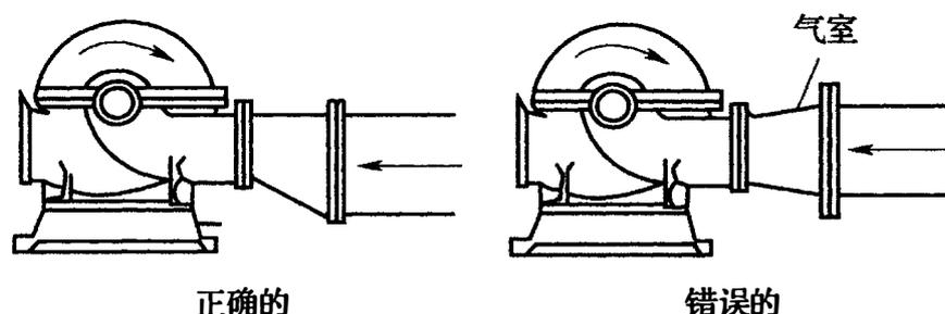
图4 正确和错误的水泵吸水管安装示意
